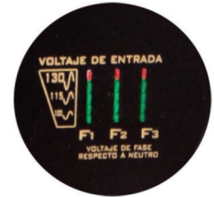
Indicadores de Voltaje de acometida
